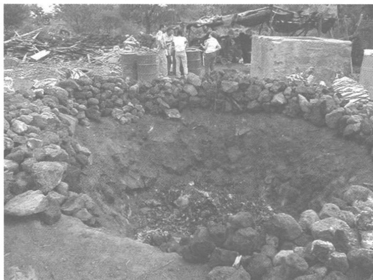
Figura 4. Horno con paredes de tierra usado para la cocción de mezcal en el estado de Durango
