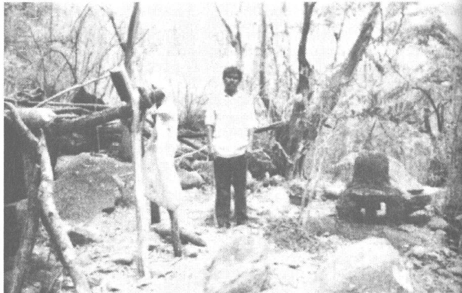
**Figura 6.** Mezcalero de la comunidad de Guadalupe Ocotán, Nayarit. Se aprecia a su derecha el fermentador elaborado con piel de vaca y a su izquierda el alambique de “anillos” ya recubierto de lodo y listo para destilar.
