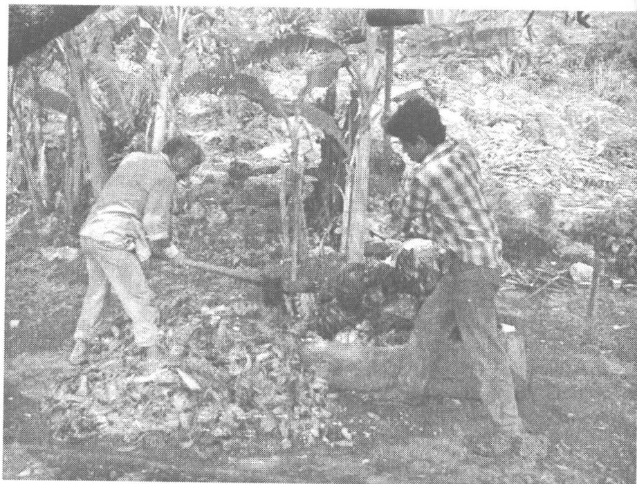
**Figura 3.** Majado del maguey cocido en la población de Sola de Vega en el Municipio de Sola de Vega, Oaxaca. Se aprecian los mazos y el esfuerzo físico que esta actividad demanda.
